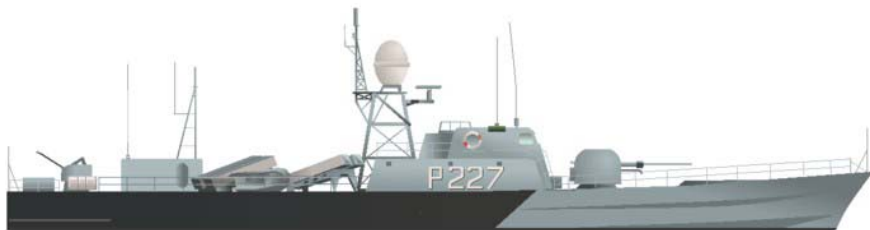
Missilbåd af Kaman-klassen. Bevæbnet med 1 x 76mm Oto Melara, 2 x 40mm antiluftsskyts og 4 Harpoon sømålsmissiler. Deplacement 249 tons. Topfart ca. 37 knob. Besætning 31 mand. 45
