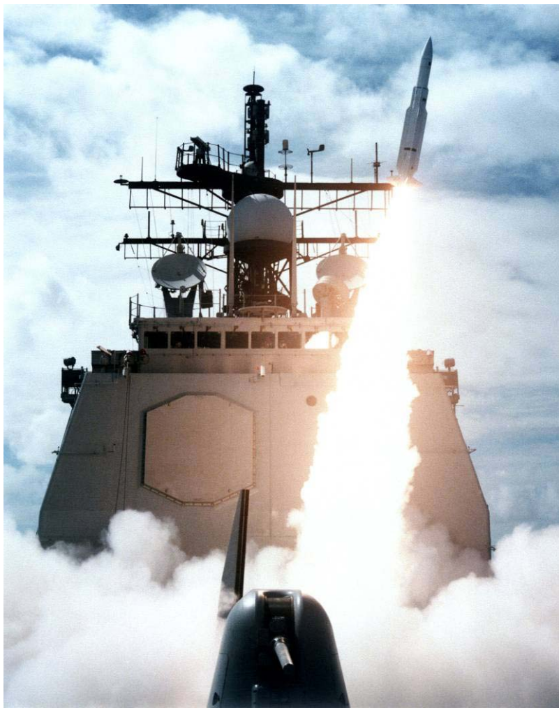
Et SM-2 missil affyres fra Vincennes' forreste launcher ca. 1987. Missilet havde en topfart på mach 2 og en rækkevidde på 18 sømil – men kunne ikke engagere mål tættere på end 10 sømil, da missilet da ikke kunne nå den nødvendige fart til at manøvrere. 70
