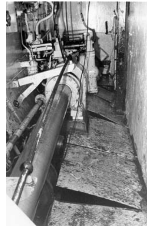
Skader på FYENS Skrog. Til venstre skibets stævn og til højre trykkede plader i akselgangen. Trods den efterfølgende reparation af skibet forvandt det aldrig skaderne helt. FYENS topfart nåede aldrig samme niveau som før grundstødningen, og maskineriet blev plaget af en række lyde, som ikke havde været der før den 7. marts 1979. (Marinens Biblioteks arkiv)
