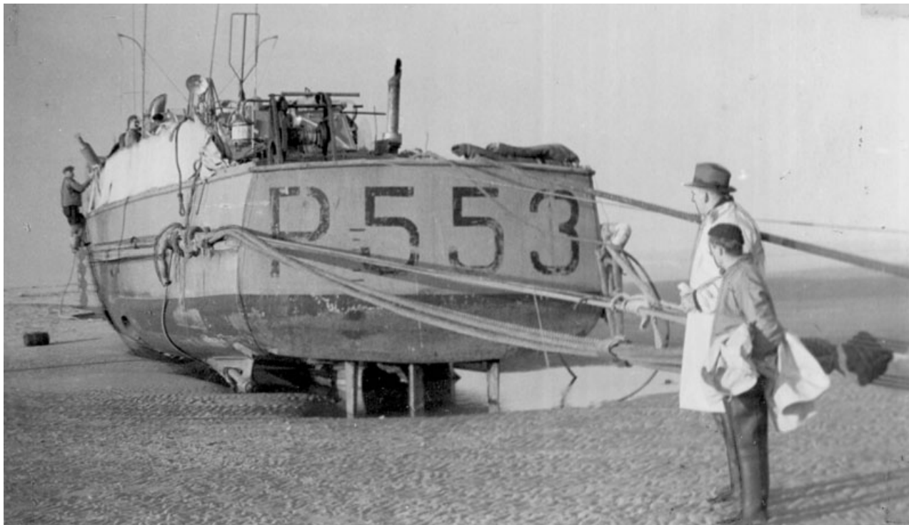
ILL: 07. High and dry! P553 HAVØRNEN på grund på Scroby Sands. Da skruer og ror er fjernet kan billedet dateres til efter 26. december 1952. Bemærk den manglende ræling på agterdækket. Et tydeligt bevis på skaderne efter en lang række sprængte slæbewirer. (Helge Nielsen)
